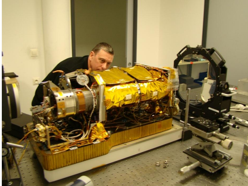
Figure 2 Remise à niveau du télescope SODISM II et contrôle optique au LATMOS (Guyancourt)
